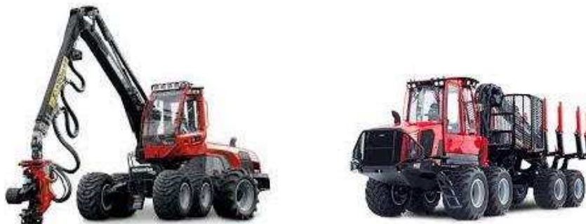
Bild 7: Harvester- Forwarder- Kombination (HFK) zur Holzernte. Energieverbrauch weniger als 0,5 % der geernteten Holzenergie.
